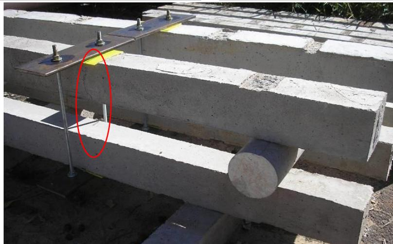
Figura 8. Mapeo de fisuras en modelos de hormigón que ha estado bajo carga central permanente durante 24 meses (M24umCCP).
