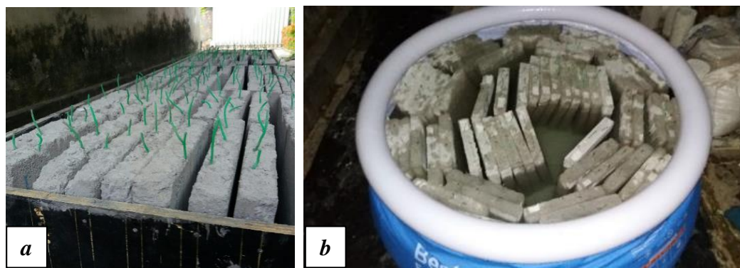
Figura 6. (a) Muestras de hormigón fundido; (b) Losas de hormigón insertadas en una solución de NaCl para la inducción de iones de cloruro.
