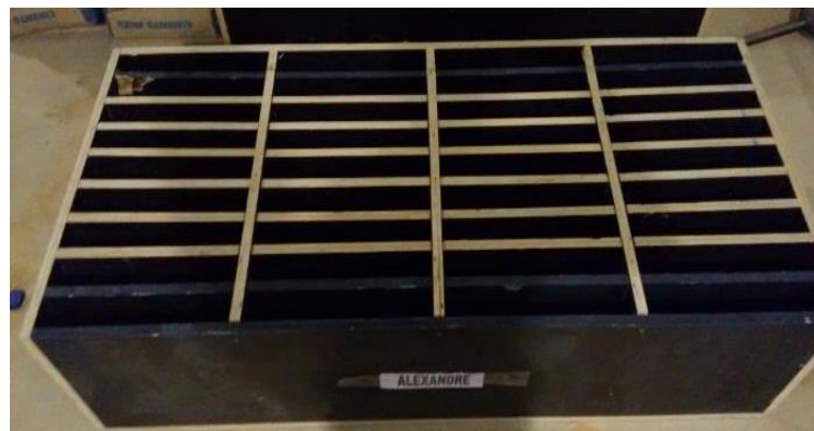
Figura 4. Molde retangular com capacidade de produzir 36 fôrmas.
