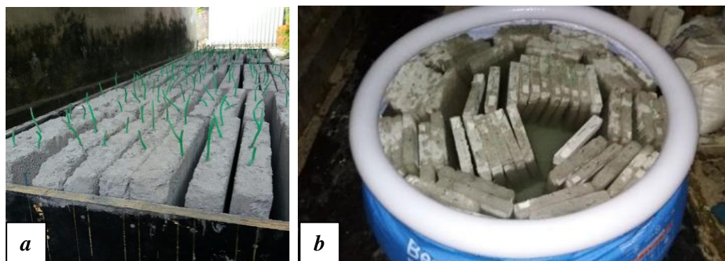
Figura 6. (a) Corpos-de-prova de concreto moldados; (b) Placas de concreto inseridas em solução de NaCl para indução de íons cloreto.
