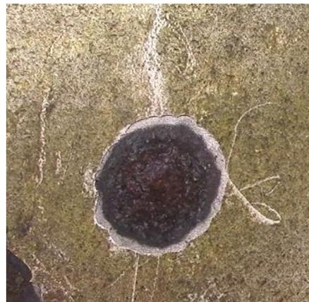
Figura 16. Zona limítrofe da área corroída sem corrosão (Ribeiro Filho, 2018)
