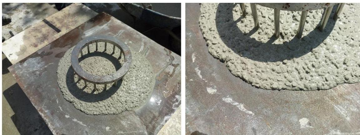
Figura 5. Detalhe do ensaio de habilidade passante através do anel J, realizado em laboratório durante o estudo de dosagem.
