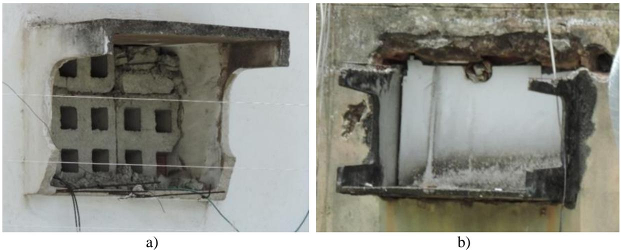
Figura 13. Quebra parcial em modelo tipo janela, aberta: a) ausência de laje inferior; b) ausência da laje superior
