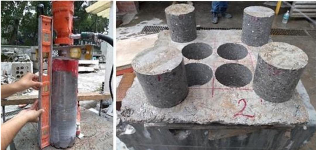
Figura 10. Extracción de testigos para Ensayo Barcelona.
