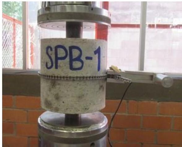
Figura 11. Ensayo de doble punzonamiento, configuración, UNE 83515
