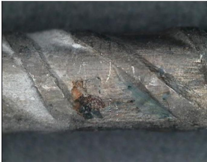
Figura 4. Pequeña zona despasivada debido al ataque por cloruros.
