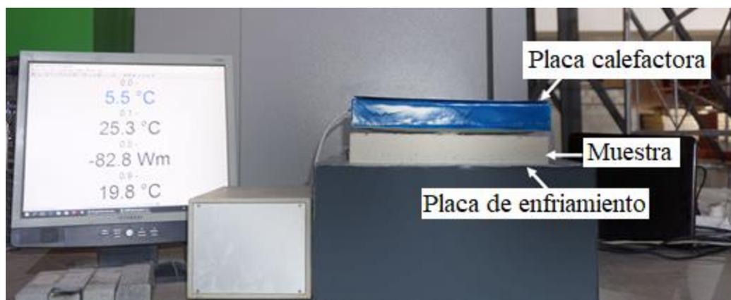
Figura 2. Configuración de la prueba de conductividad térmica.
