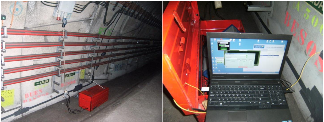
Figura 8. Carretel de fibra ótica restante sujeito à estrutura e ODiSI (Optical Distributed Sensor Interrogator, da LUNA Technologies, Modelo A50) em operação.
