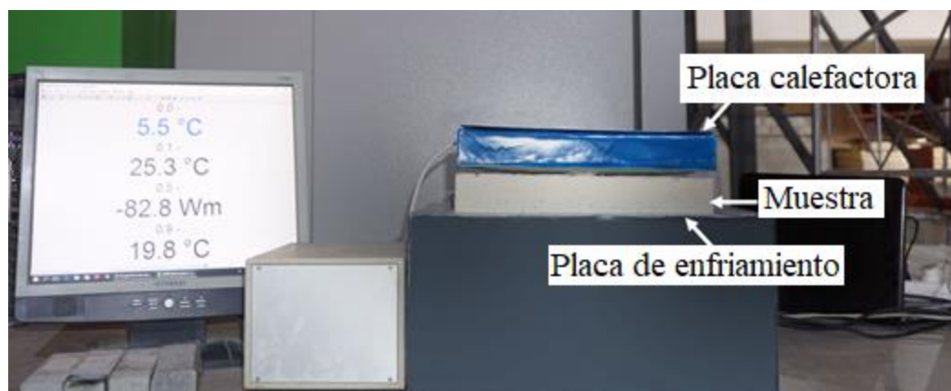
Figura 2. Configuración de la prueba de conductividad térmica.
