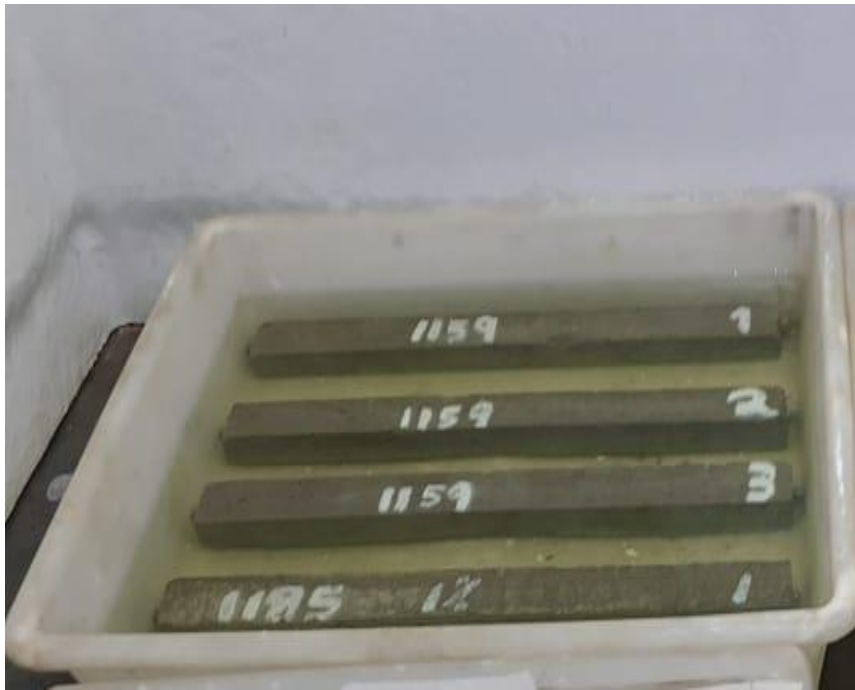
Figura 3. Probetas de mortero sumergidas en solución de NaOH para el cumplimiento de los ensayos de expansión.
