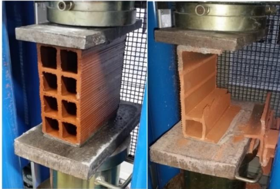
Figura 6. Resistencia a la compresión.
