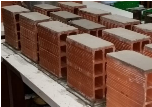
Figura 3. Copeamiento de bloques cerámicos.
