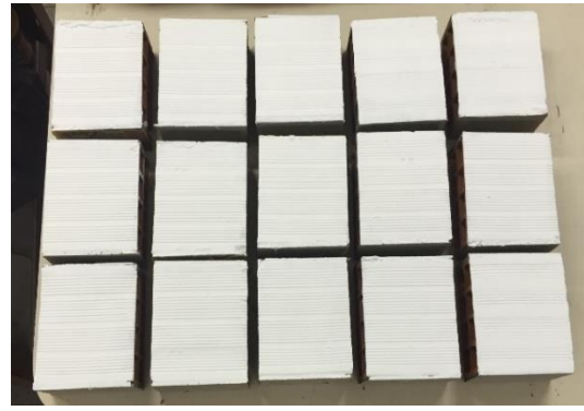
Figura 4. Aplicación de tinta intumescente.
