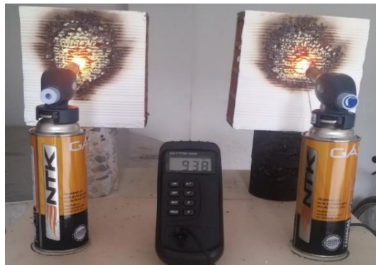
Figura 5. Aplicación de tinta intumescente.
