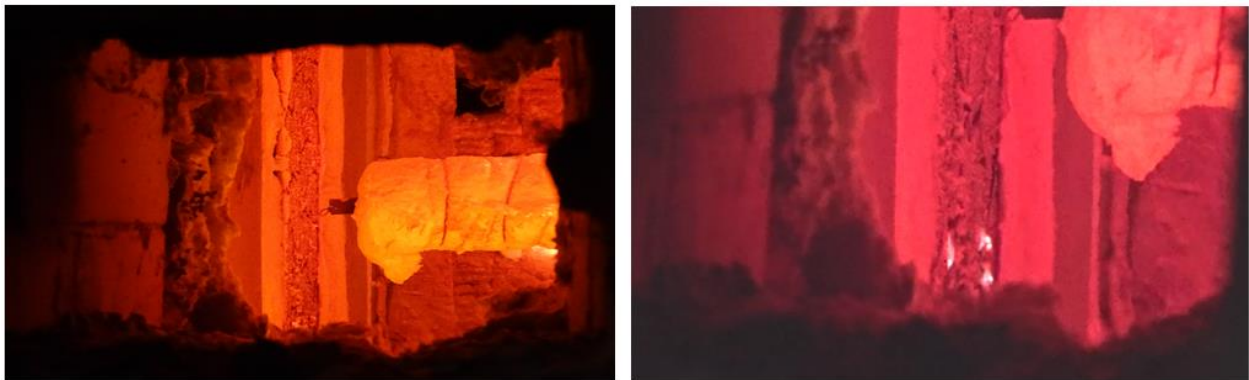
Figura 6. Detalle de la apariencia "elemento al rojo vivo" del elemento intumescente recubierto de pintura a la izquierda, y pequeños puntos brillantes en este mismo elemento (a la derecha).
