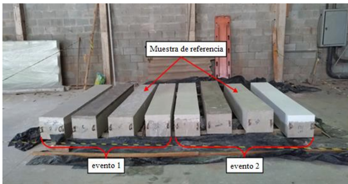
Figura 3. Detalle de elementos terminados con todos los recubrimientos aplicados, excepto las dos muestras de referencia.
