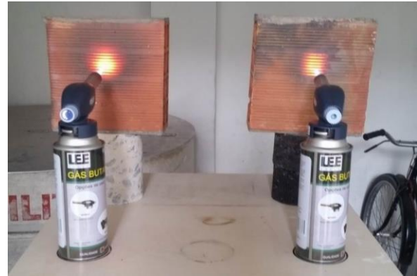
Figura 7. Bloques sin protección pasiva.
