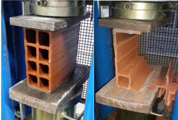
Figura 6. Resistência à compressão.
