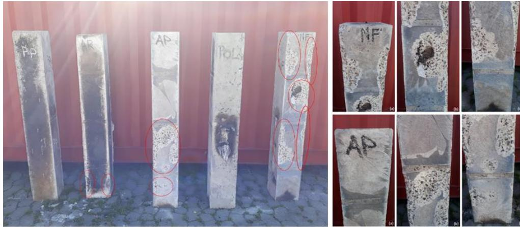
Fig. 10. Pilares após serem submetidos ao fogo, destacando NF e AP pós fogo, mostrando o topo (a), centro (b) e base (c).
