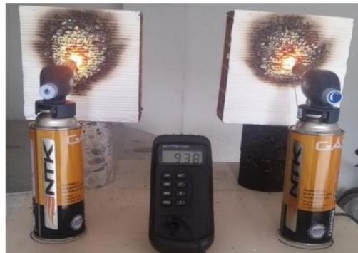
Figura 5. Aplicação da tinta intumescente
