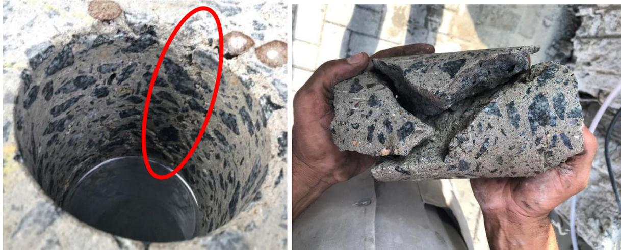
Figura 13. Fissuras visíveis durante a extração e testemunho descomposto. (fonte: acervo pessoal de Paulo Helene)
