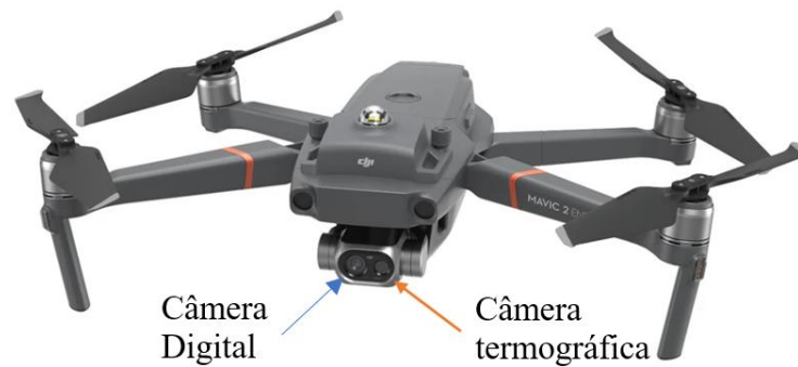
Figura 3. VANT con cámara termográfica acoplada a la cámara digital. (Topdrone, 2020).
