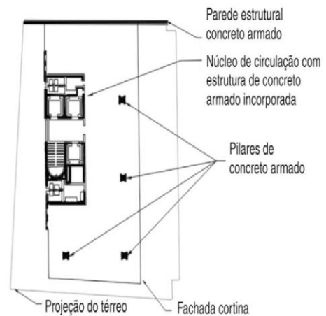
Figura 6 - Plano esquemático del pavimento tipo Wilton Paes de Almeida
