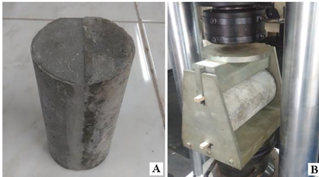
Figura 3. (A) Muestra para determinar la adhesión entre la reparación y el hormigón; (B) Prueba para determinar la adhesión entre la reparación y el concreto por compresión diametral
