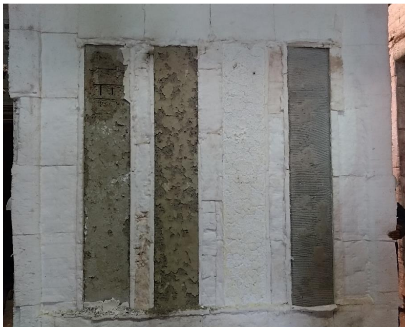
Figura 7. Detalle del estado de los elementos y revestimientos después de la apertura del horno (evento 2): revestimiento de yeso lento de mercado, elemento de referencia, revestimiento de pintura intumescente y revestimiento de mortero base cemento.
