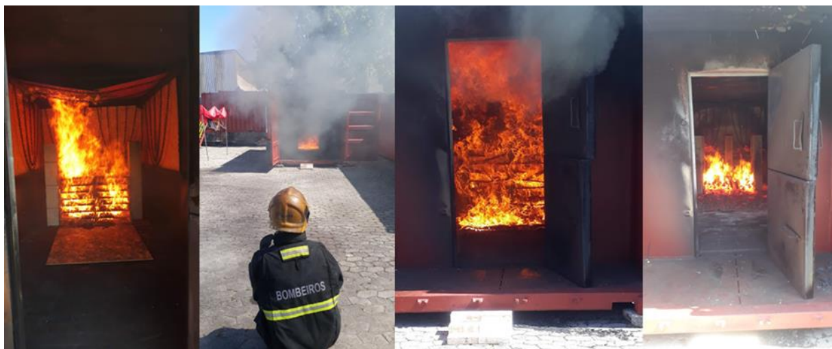
Fig. 3. Simulação de incêndio real nos protótipos
