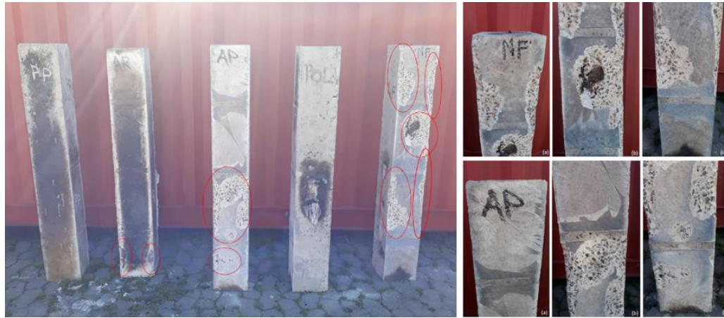
Fig. 10. Pilares após serem submetidos ao fogo, destacando NF e AP pós fogo, mostrando o topo (a), centro (b) e base (c).
