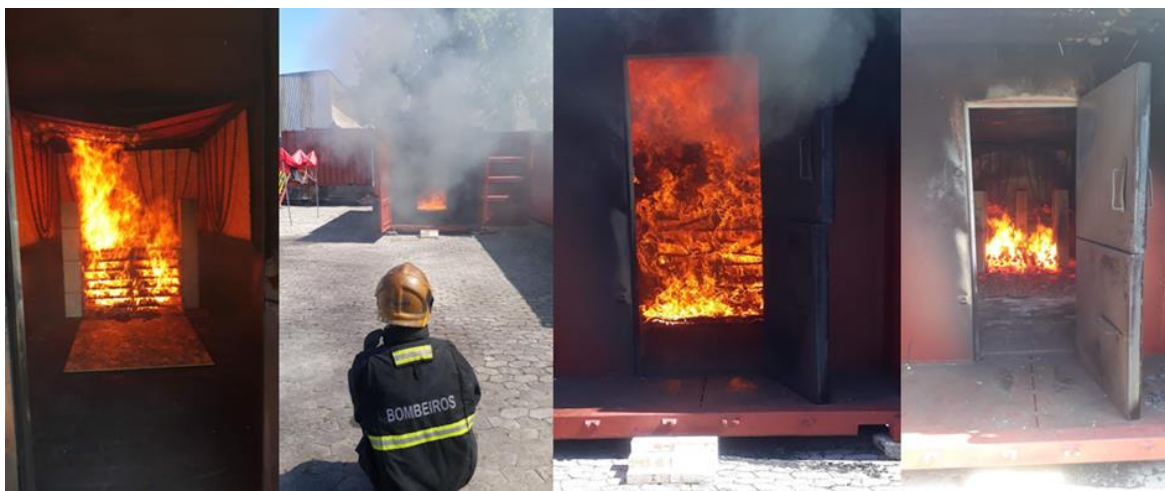
Fig. 3. Simulación de fuego real en los prototipos - columnas.
