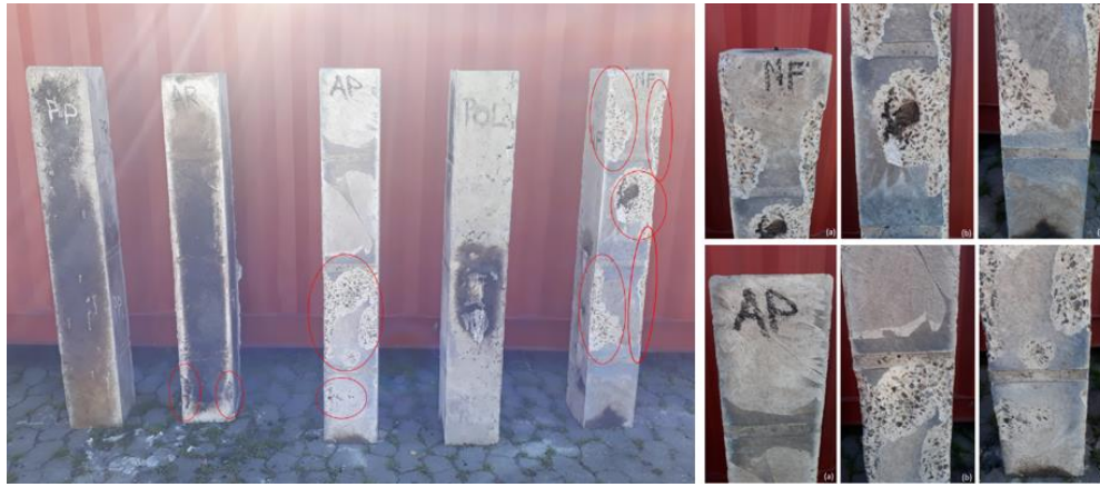
Fig. 10. Columnas después de haber sido expuestas al fuego. Observar NF y AP después del fuego, mostrando la parte superior (a), el centro (b) y la base (c).
