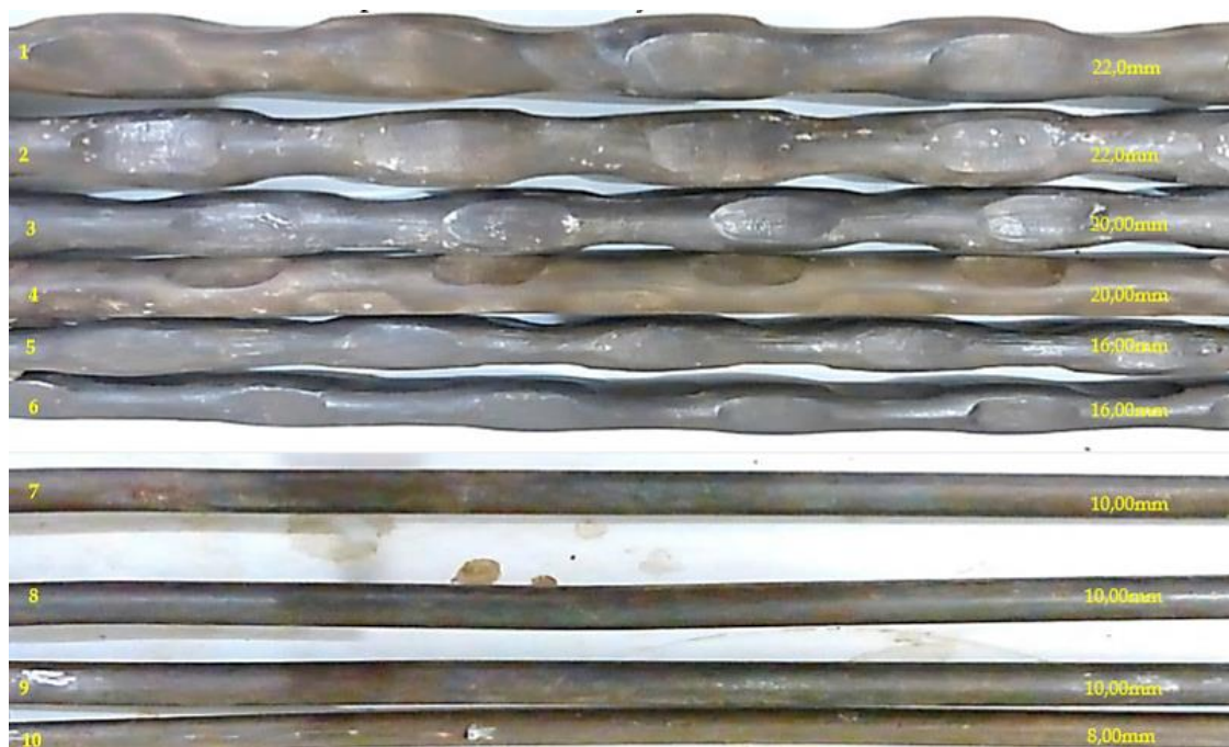
Figura 14. Clasificación de muestras de acero según su calibre (fuente: Arcelor Mittal)
