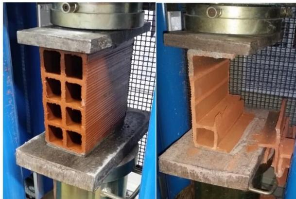
Figura 6. Resistência à compressão.
