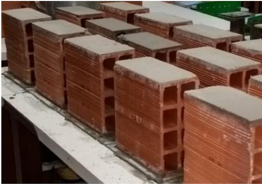
Figura 3. Capeamento dos blocos cerâmicos.
