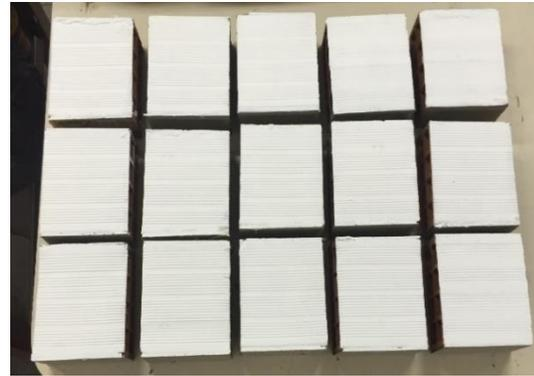
Figura 4. Aplicação da tinta intumescente.
