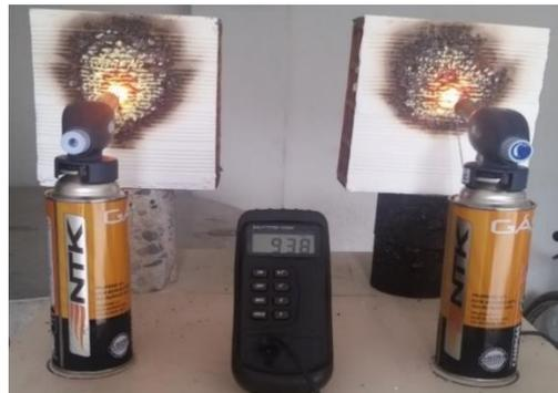
Figura 5. Aplicação da tinta intumescente
