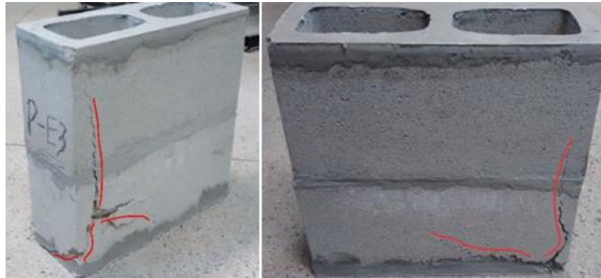
Figura 3. Ruptura típica dos prismas
