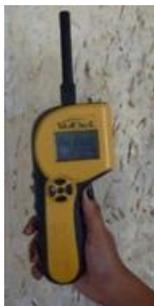
Figura 21. Termo-higrómetro.
