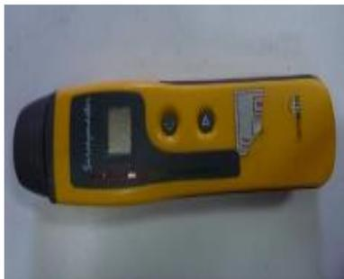
Figura 22. Higrómetro *Protimeter Surveymaster SM*.
