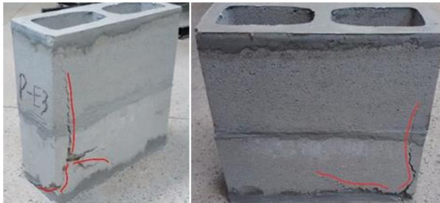
Figura 3. Ruptura típica de los prismas
