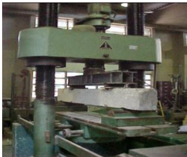
Figura 6. Prensa usada para os ensaios de flexão de vigas
