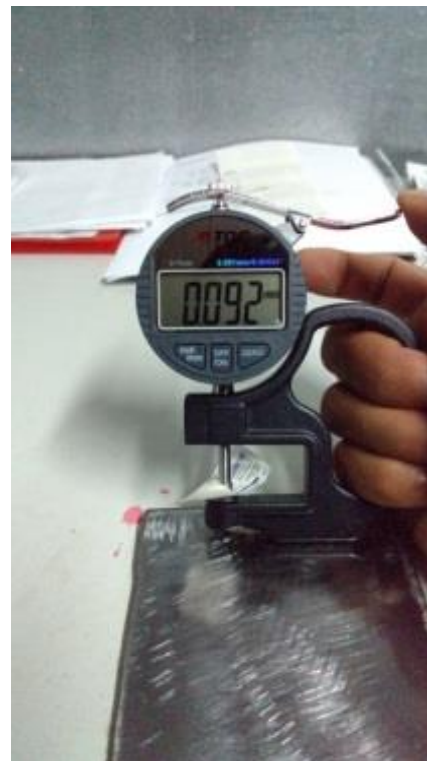
Figura 2. Rugosímetro em chapa padrão St3 (Ribeiro Filho, 2018)
