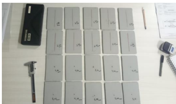
Figura 5. CPs com danos experimentais à película (Ribeiro Filho, 2018)
