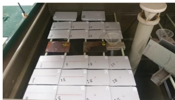
Figura 6. CPs na câmara salina antes da exposição à névoa (Ribeiro Filho, 2018)
