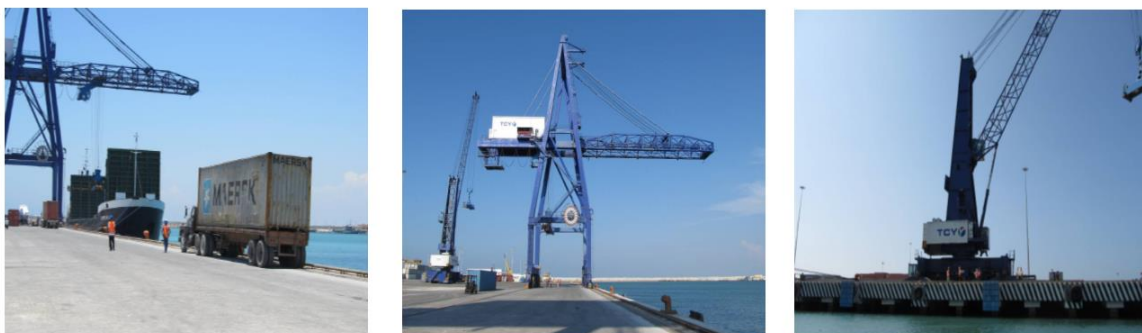
Figura 3. Plano geral de posição do caminhão e tipos de carga aplicados durante o ensaio (da esquerda para a direita, caminhão, pórtico e guindastes Gottwald).
