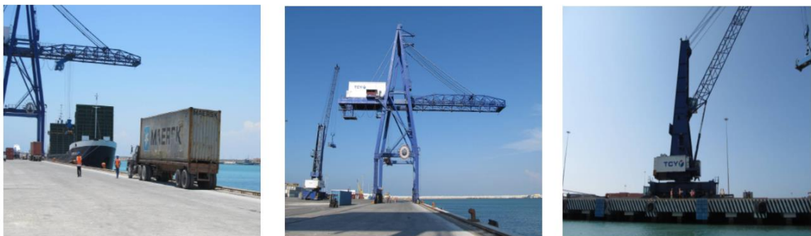
Figure 3. Posición general de camión de carga generada por el camión plan y tipos de carga aplicadas en las pruebas (de izquierda a derecha camión grúas pórtico y Gottwald).
