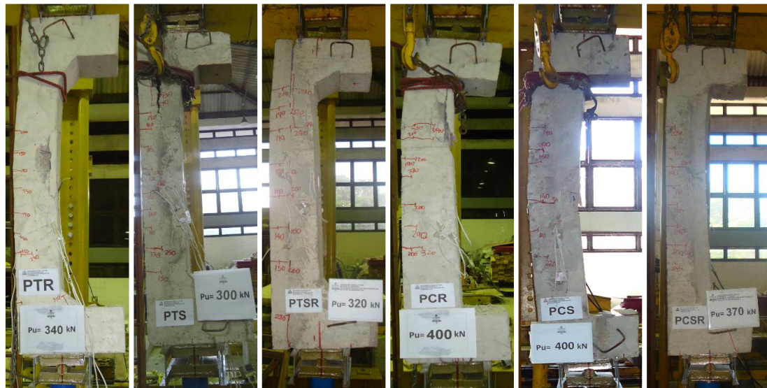
Figura 10. Columnas posteriores a la ruptura.
