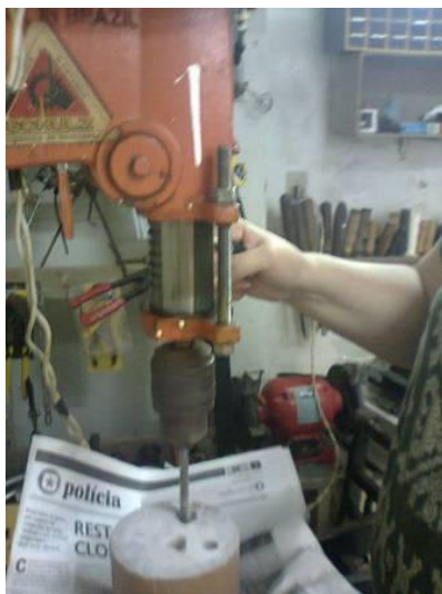
Figura 4. Ensayos de perforación con taladro fijo.
