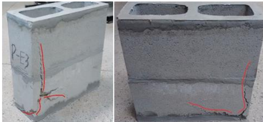
Figura 3. Ruptura típica de los prismas
