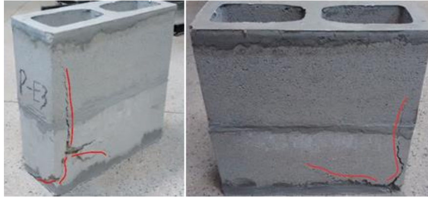
Figura 3. Ruptura típica dos prismas
