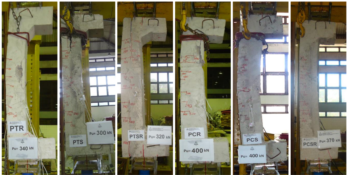
Figura 10. Pilares após a ruptura.
