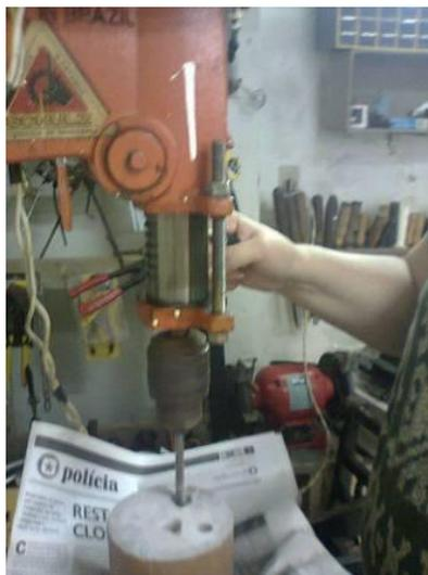
Figura 4. Ensayos de perforación con taladro fijo.
