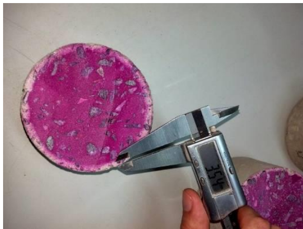
Figura 11. Medición de la profundidad de carbonatación para peso específico de 1700 kg/m 3
