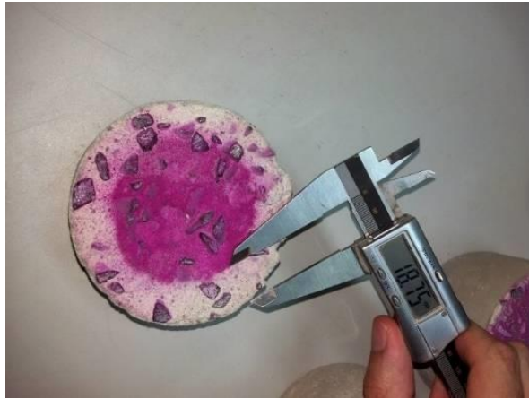
Figura 10. Medición de la profundidad de carbonatación para peso específico de 1500 kg/m 3
