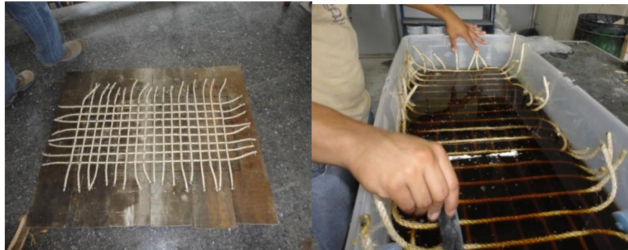
Figura 1. Arranjo e impregnação do tecido de fibras naturais.
