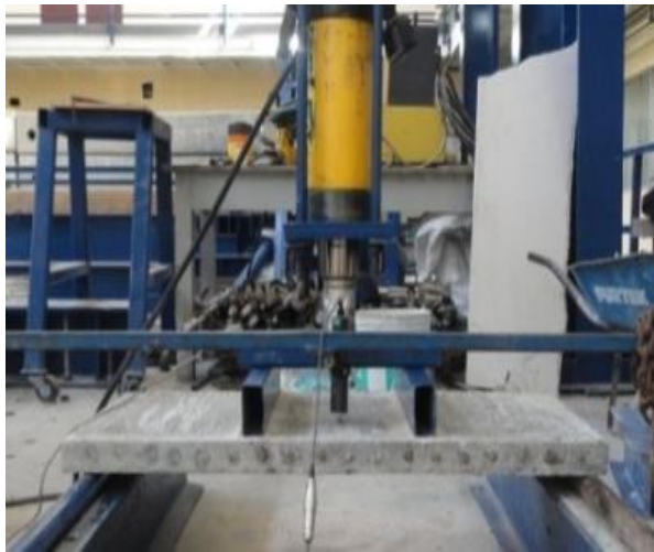
Figura 2. Ensaio de flexão dos painéis reforçados com fibra.
