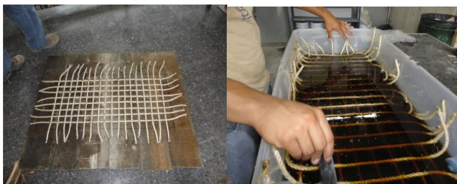
Figura 1. Arreglo e impregnación de la malla de fibra natural.
