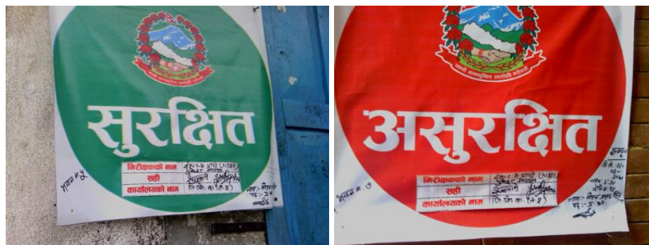
Adhesivos: Categoría segura e insegura de edificios Figura 2. Evaluación Rápida de Vulnerabilidad
