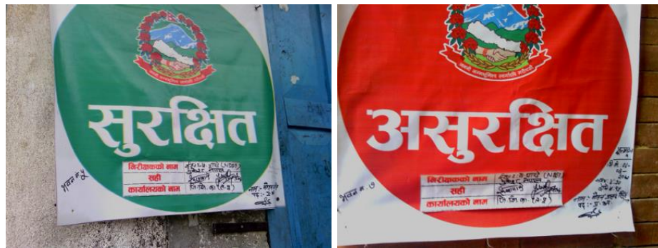
Adesivos: Categoria segura e insegura de edifícios Figura 2. Avaliação Rápida de Vulnerabilidade
