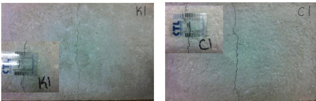
Figura 5. Espesor de fisuras de Control (C1) cuando se compara con K1 (condiciones modificadas) - indicando un CRR aproximado de 55%.
