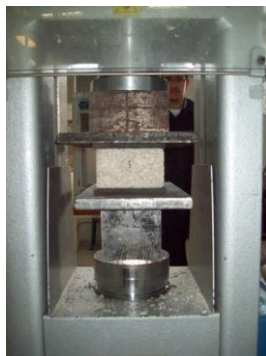
a) bloco na máquina universal
