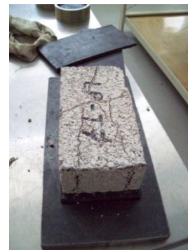
b) Falha típica do bloco
