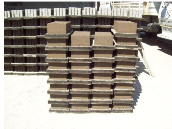
b) Compactação e cura dos blocos
