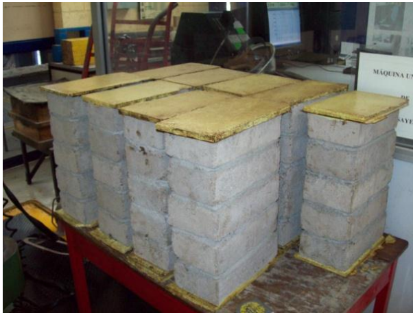
a) Preparação de prismas para o ensaio
