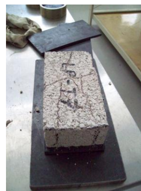
b) Falla típica de la pieza
