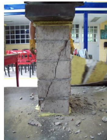
b) Falla típica obtenida
