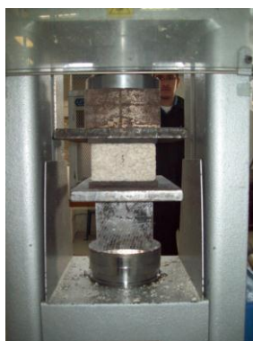
a) Pieza en máquina universal
