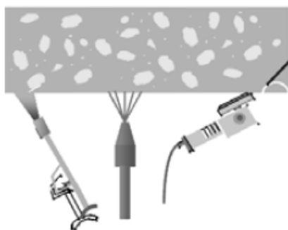
Figura 16b. Esquema de aplicación de chorro de aire y rebajado de las esquinas.
