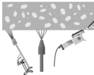
Figura 16b. Esquema de aplicación de chorro de aire y rebajado de las esquinas
