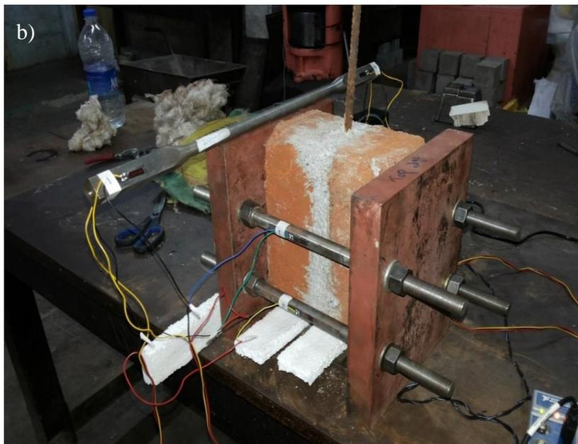
Figure 2. (a) Muestra mantenida en posición (b) Configuración del ensayo de *pull-out*.
