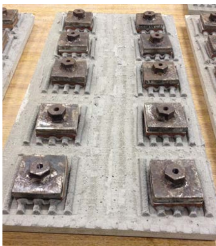
Figura 4. Piezas metálicas pegadas sobre las placas cerámicas adheridas al sustrato-patrón.
