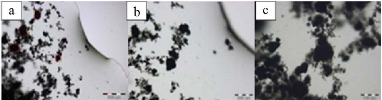
Figure 6. Amostra SM 2 – NTC em pó disperso em água e aditivo à base de policarboxilato (Tec Flow 8000 - 2%).
