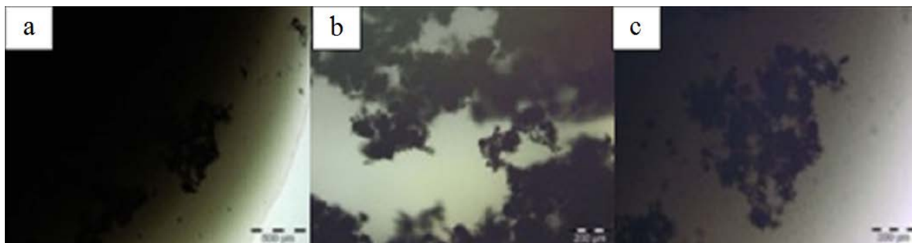
Figura 14. Amostra SM 10 - NTC Aquacyl 0301 disperso em água, com NTC em pó e aditivo á base de policarboxilato (Tec Flow 8000 – 0,5%).
