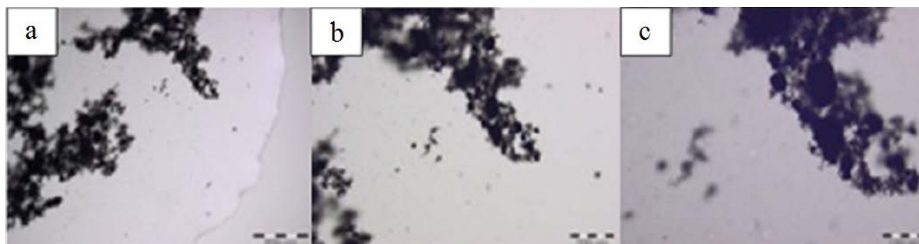
Figura 15. Amostra SM 11 – NTC em pó disperso em água e goma arábica.
