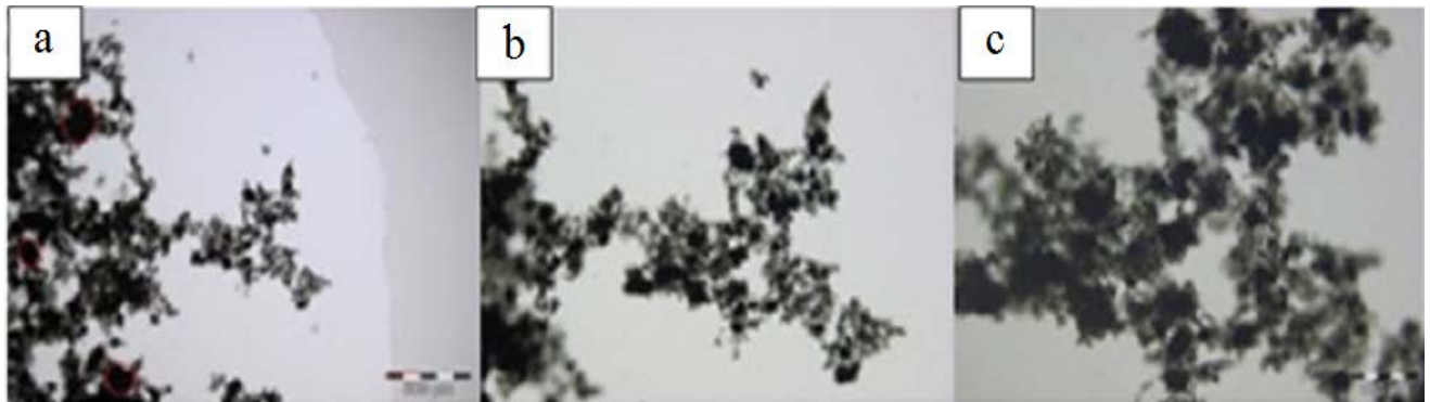
Figura 7. Amostra SM 3 – NTC em pó disperso em água e aditivo à base de policarboxilato (Tec Flow 8000 - 1%).
