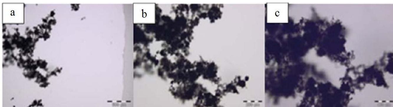
Figura 16. Amostra SM 12 – NTC em pó disperso em água e surfactant.
