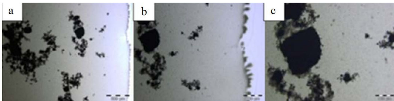
Figura 10. Amostra SM 6 - NTC Aquacyl 0301 disperso em água, com NTC em pó e aditivo à base de policarboxilato (Tec Flow 8000 - 1%).
