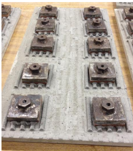
Figura 4. Peças metálicas coladas sobre as placas cerâmicas aderidas ao substrato-padrão.
