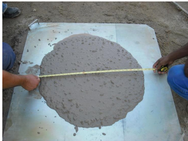
Figura 9. Aferição do espalhamento ( slump-flow ) do concreto.
