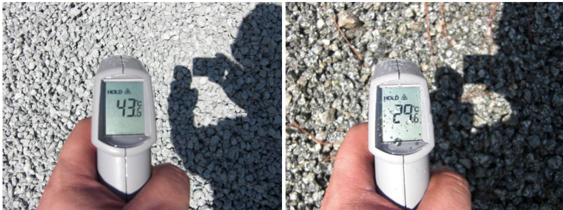
Figura 7. Registro da temperatura dos agregados graúdos antes e após a aspersão de água na central de concreto.
