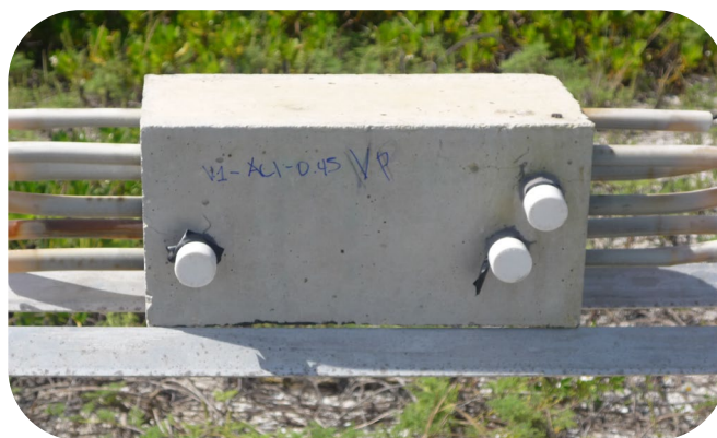
Figura 1. Corpo de prova e seu esquema de exposição, com o maior cobrimento na face inferior.
