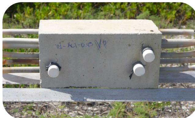
Figura 1. Probeta y su esquema de exposición, el recubrimiento mayor en el lecho inferior.
