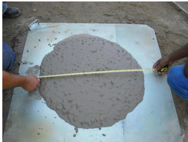
Figura 9. Aferição do espalhamento ( slump-flow ) do concreto.
