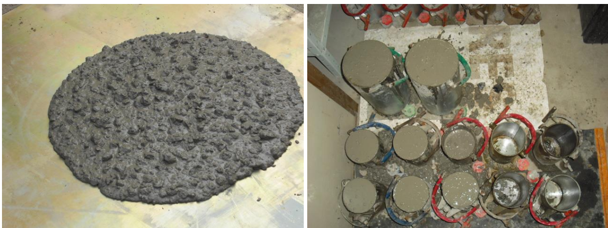
Figura 4. Espalhamento ( slump-flow ) e corpos de prova sendo moldados para os ensaios de resistência à compressão.
