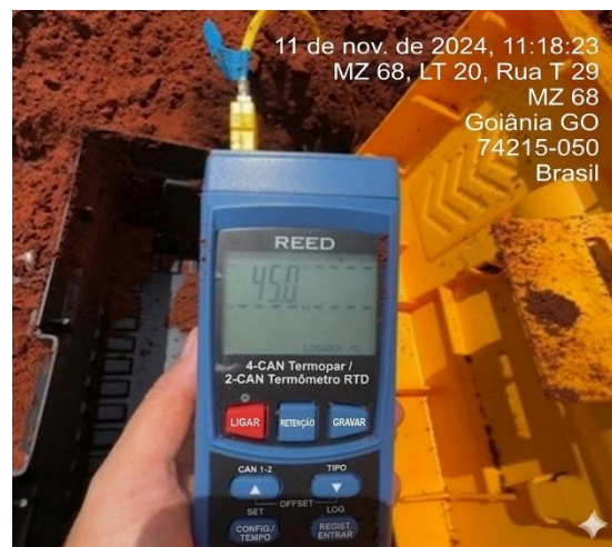
Figura 9. Registro com T = 45,0\text{ }^{\circ}\text{C} após 72 horas do bloco de prova.
