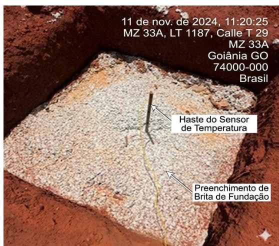
Figura 8. Registro do bloco de prova após 72 horas.
